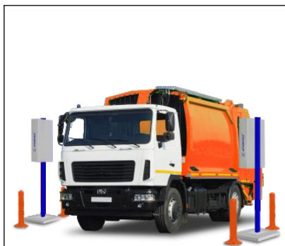
Вариант транспортного монитора в составе: БДКГ-19 (2 шт.), БДКН-05 (2 шт)
