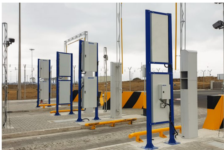
Вариант транспортного монитора в составе: БДРМ-05 (8 шт.), БДКН-05 (8 шт)
