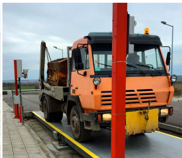
Вариант транспортного монитора в составе: БДРМ-05 (8 шт.), БДКН-05 (8 шт)
